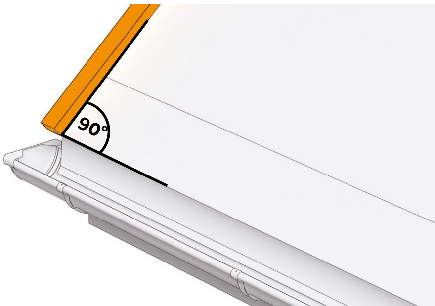
RYS.10 LISTWA WIATROWNICY - JEDNO Z MOŻLIWYCH ROZWIĄZAŃ
