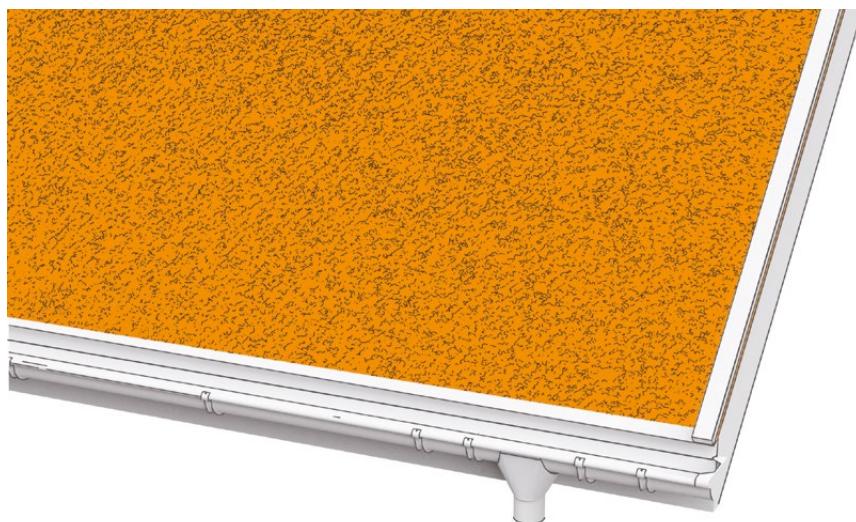
RYS.9 MATA DYSTANSOWA / MEMBRANA Z OPLOTEM
